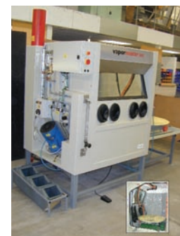
Sableuses à eau • Ouverture sur le côté • Intérieur dès 950x950x1330 mm
